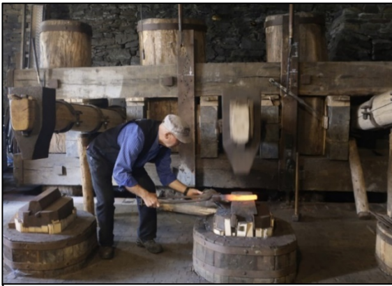
Herr Schade vom Freibergsdorfer Hammer e.V. schmiedet einen Nagel mit Kopf
