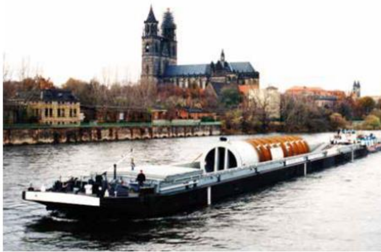
Eines der bisher schwersten Güter, die per Schiff durch Magdeburg gefahren wurden, war 1994 ein Generator von 520 Tonnen in einem Ro-Ro-Schubleichter auf der Fahrt von Hamburg nach Pfützthal an der Saale. (Foto: Christian Knoll)
