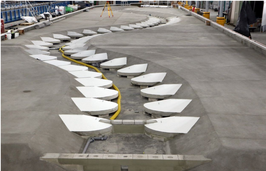
Bild 2: Krümmungsmodell der BAW kurz vor der Fertigstellung
