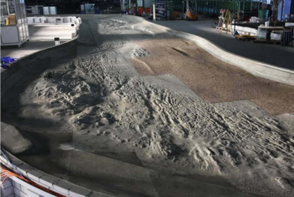
Modell zur Abladeoptimierung Mittelrhein (WSA Duisburg-Rhein), Maßstab der Länge: Modellsohle trocken liegend
