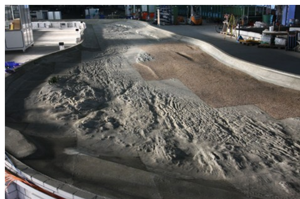
Modell zur Abladeoptimierung Mittelrhein (WSA Duisburg-Rhein), Maßstab der Länge: 1:60 und der Höhe: 1:50
