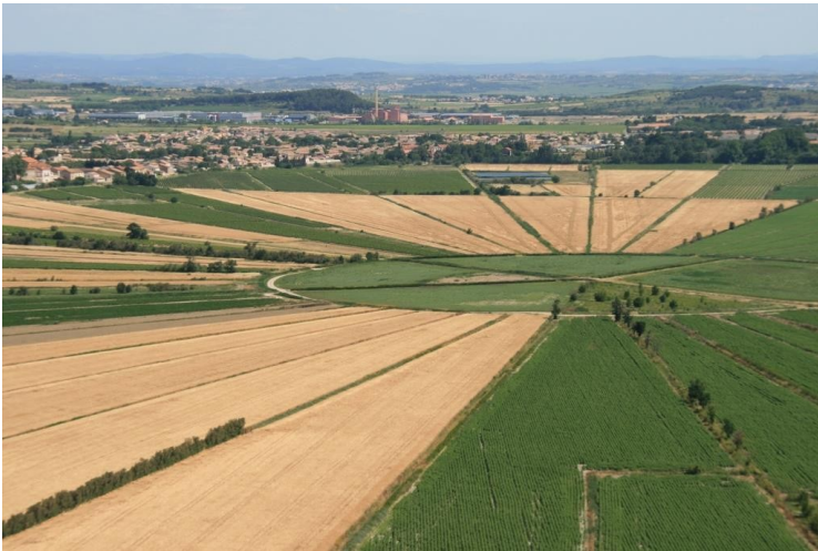
Abb. 1: Der Etang de Montady im Département Hérault. Gut zu erkennen sind die radialen Entwässerungsgräben. Die Ableitung des Wassers aus dem trockengelegten See erfolgte über einen Stollen in Qanatbauweise (Foto: N. Kupfer)
